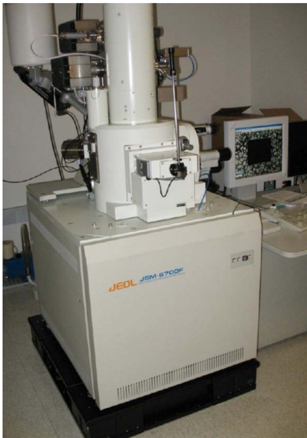
Abb. 4 STACIS-Isolation ist auch bei kleineren Geräten möglich, z. B. bei Raster-Elektronen-Mikroskopen (Bild: TMC)
